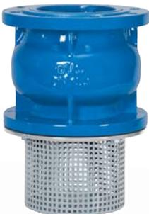
Dip Klapelelerinde Silent çekvalf girişine bir filtre monte edilir Bu tip vanalar, pompa emme hattı girişine monte edilir ve boru hattının boşalmasını önler. Ayrıca paslanmaz çelik filtre, boru hattına partikül girmesine izin vermez girmesine izin vermez. Çekvalfler, GG25, GGG40 – 40,3 - 50, GSC25, SS304, SS316 ve NAB malzemelerden üretilebilmektedir.
